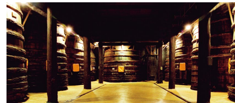
イチビキで現在も使用されている「丈三桶」。「丈三桶」とは、明治44年に初代社長の中村慶蔵が考案したもので、桶底の直径が1丈3尺（約3.9m）、高さ1丈3尺（約3.9m）、容量約50という日本最大級の仕込桶。100年以上たった現在でも現役だ
